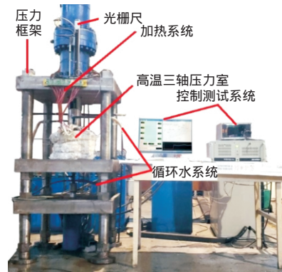
图 2 高温高压岩体力学试验机
